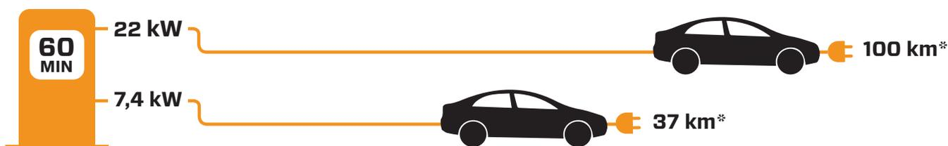
\* Cavo EV 22 kW: 1 ora di ricarica fino a 100 km per gamma EV, in base al modello di EV.
