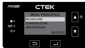
**AUTO ADATTIVA** analizza la batteria e seleziona la corrente ottimale per le dimensioni della batteria. Auto Adattiva non deve essere utilizzata per la ricarica di batterie al litio.
