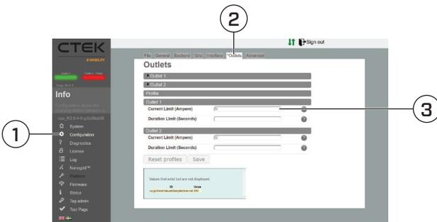
NOTA: Cambie la configuración del límite de corriente si este debe ser más bajo que el nivel del fusible del estado de carga.
